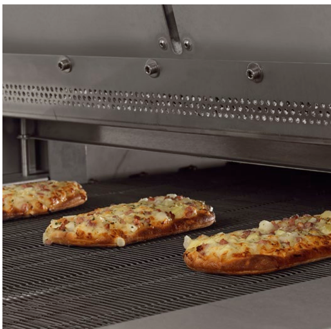
Die patentierte Technologie des Infrarot-Durchlaufofens ITES von WP Lebensmitteltechnik RIEHLE reduziert die Backzeit um bis zu 70 %.
