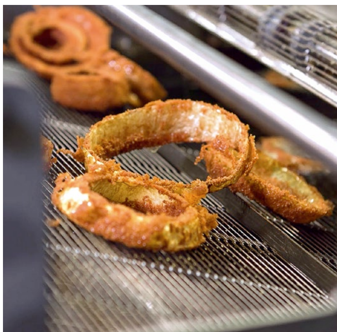
Beim Frittieren mit der WP RIEHLE Durchlauf-Frittieranlage DLA SC bleibt der Geschmack des Produkts erhalten und das Produkt nimmt möglichst wenig Fett auf.
